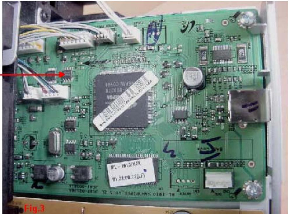
4.- Una vez ubicado el chip a resetear, la impresora debe de tener papel en la bandeja para poder imprimir, el cartucho **NO** se retira **NO** se le debe de quitar el chip, tal y como deajo de funcionar así debe de realizar el reseteo de lo contrario no se podrá resetear.
