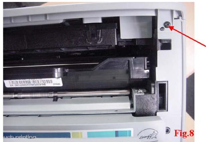
8.- Ahora retire los 3 tornillos que se muestra en la imagen con cuidado y retire la tapa posteriormente va a realizar el puenteo permanente utilizando el cable puenteando el cable negro y el cable gris no hay necesidad de soldar solo aflojar los tornillos meter el cable y apretarlos así no perderá la garantía luego ensamble nuevamente su impresora préndala y listo
